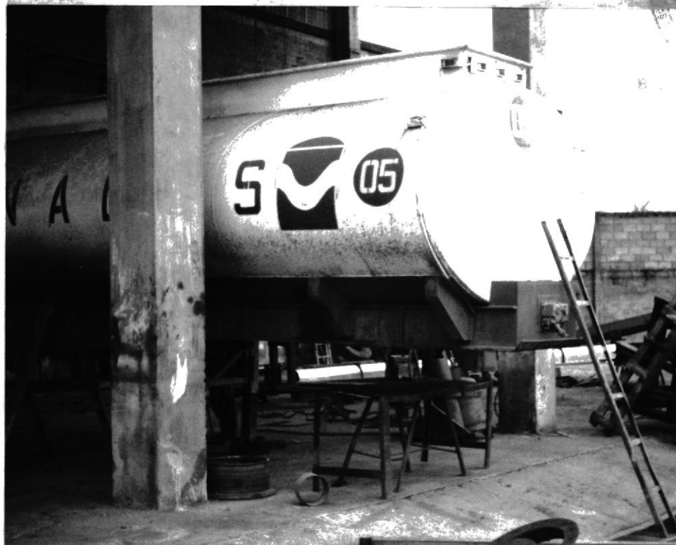
TANQUES PARA TRANSPORTE DE SODA CAUSTICA CON TAPAS REBORDEADAS, CONSTRUIDAS EN EL PAIS.
