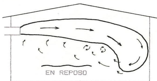
Figura 5.1 SALIDA Y MOVIMIENTO DE AIRE CALIDO
