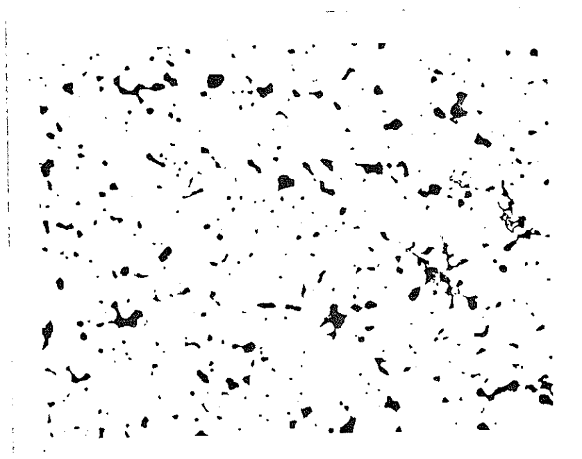
Fig. N° 24.- Bronce centrifugado 80-10-10 elaborado en la cuarta colada, sin ataque químico, 100 x.
