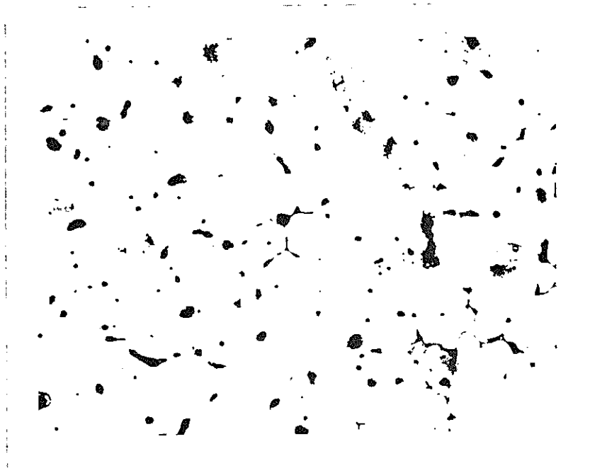
Fig. N° 18.- Bronce de Composición desconocida, usado para cojinetes de molinos de caña. Procedencia colombiana, sin ataque químico, 100 x.
