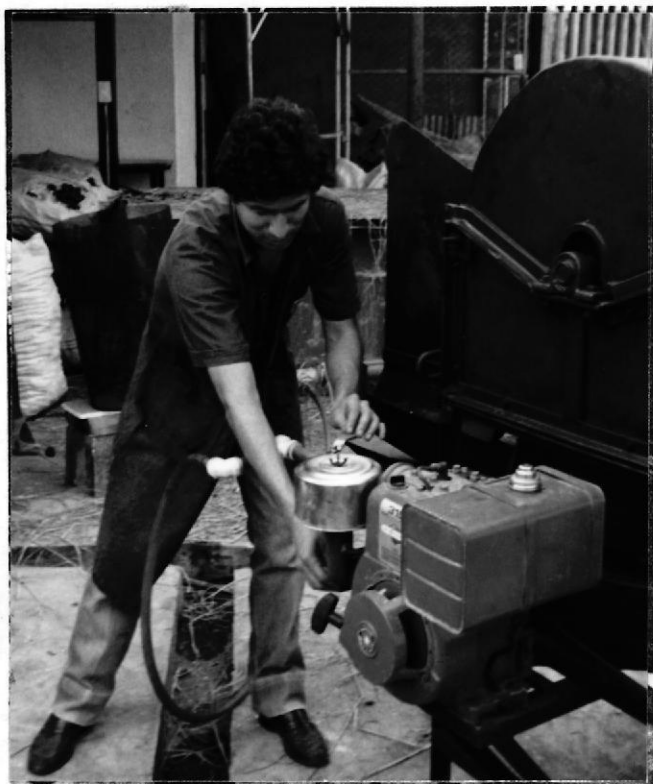
Encendido del motor con gas pobre
