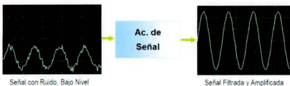
FIGURA 1.5: ACONDICIONADOR DE SEÑAL
