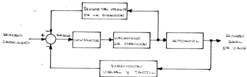
FIG. 7) SISTEMA DE CONTROL DE LA DIRECCION DE UN AUTOMOVIL
