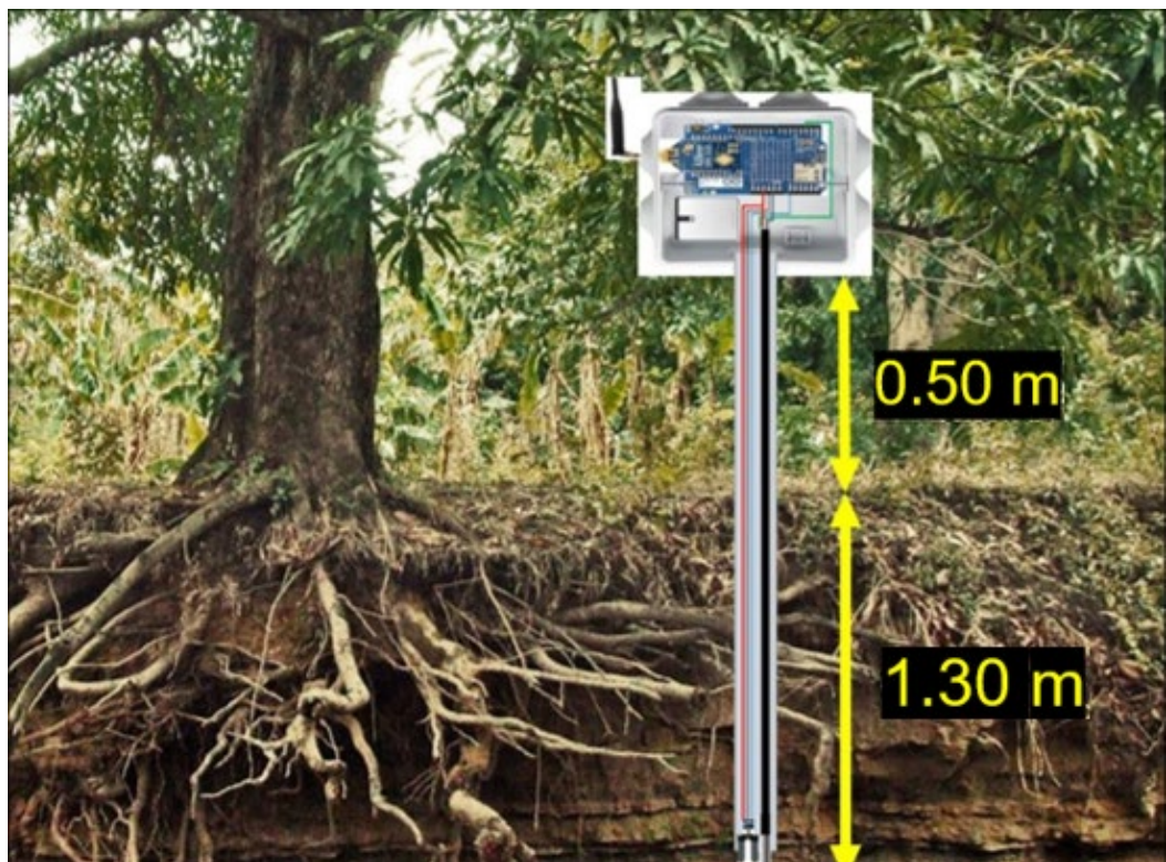
Figura 2.3 Ejemplo de implementación del nodo sensor en el terreno.
