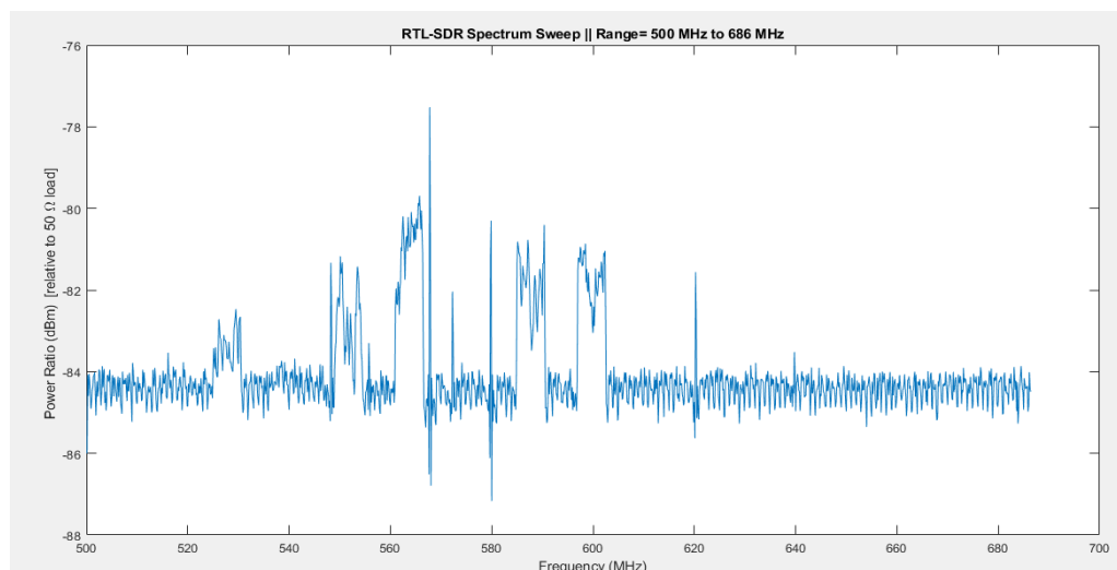
Imagen 0.6 Espectro capturado en la banda UHF de televisión.
