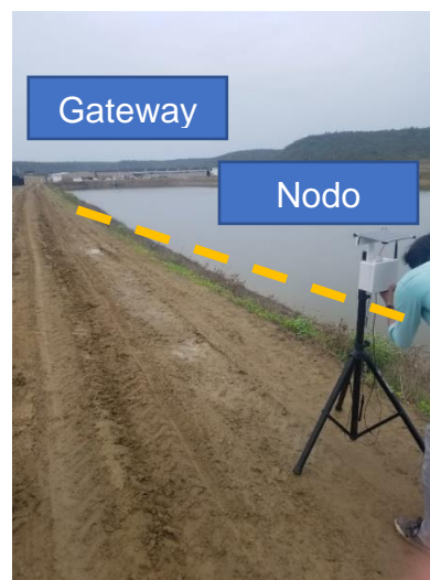
Figura 2.6 Pruebas de Nodo-Gateway con línea de vista.
