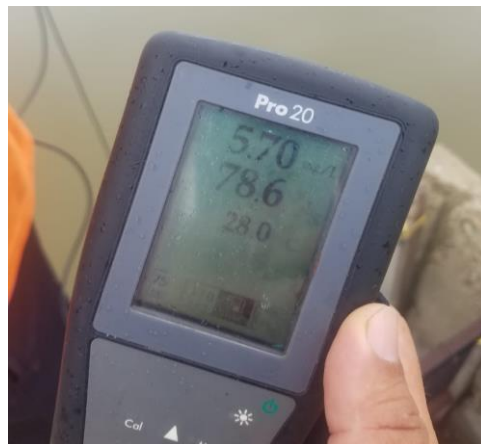
Figura 2.8 Mediciones de oxígeno disuelto y temperatura en campo con equipo manual.
