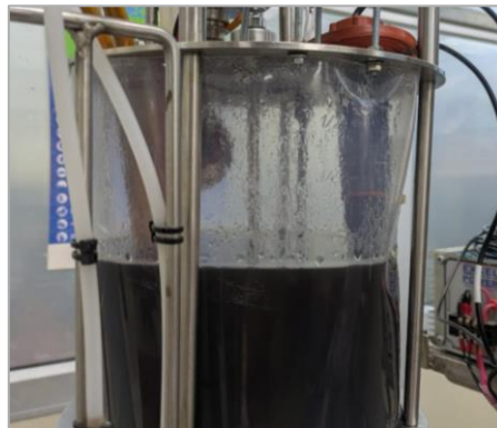
Figura 3.2 Deformación observada en el tanque durante las pruebas de lazo abierto (Autor propio, 2025)
