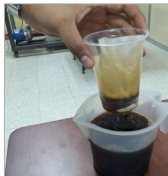
Figura 3.3 Filtrado de la sustancia inicial (Autor propio, 2025)
