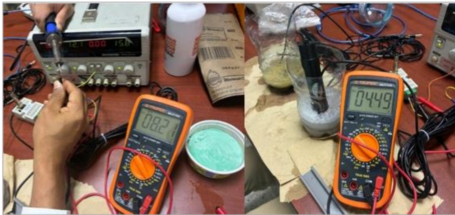
Figura 2.13 Lectura de la salida del transmisor de pH y Temperatura (Autor propio, 2025)
