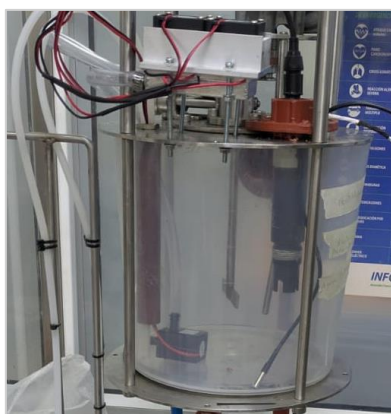
Figura 3.1 Altura de la punta de prueba de pH en el tanque (Autor propio, 2025)
