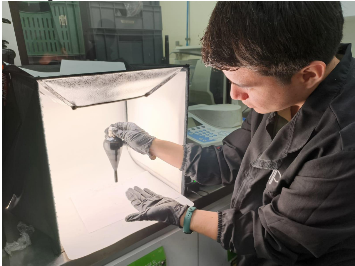
Figura 5. Ensayo BS&W al crudo deshidratado.
