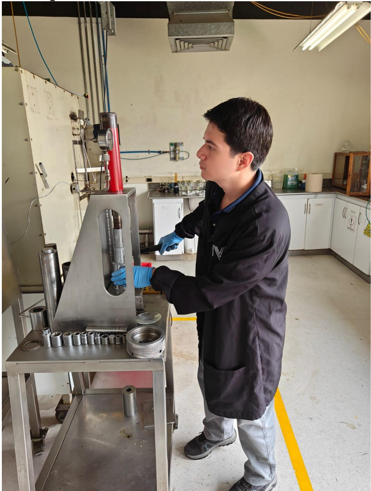
Figura 8. Fabricación de núcleos de arenas representativas de formaciones geológicas ecuatorianas.
