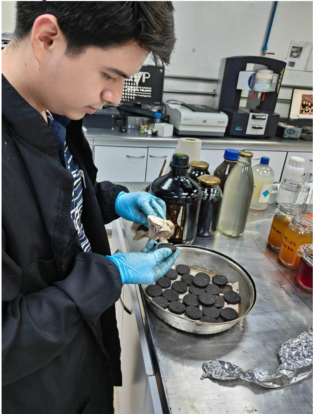
Figura 11. Limpieza de núcleos añejados.
