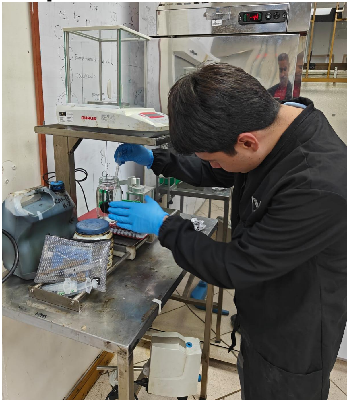
Figura 15. Remoción de burbujas durante ensayos de imbibición (10 a 180 min).
