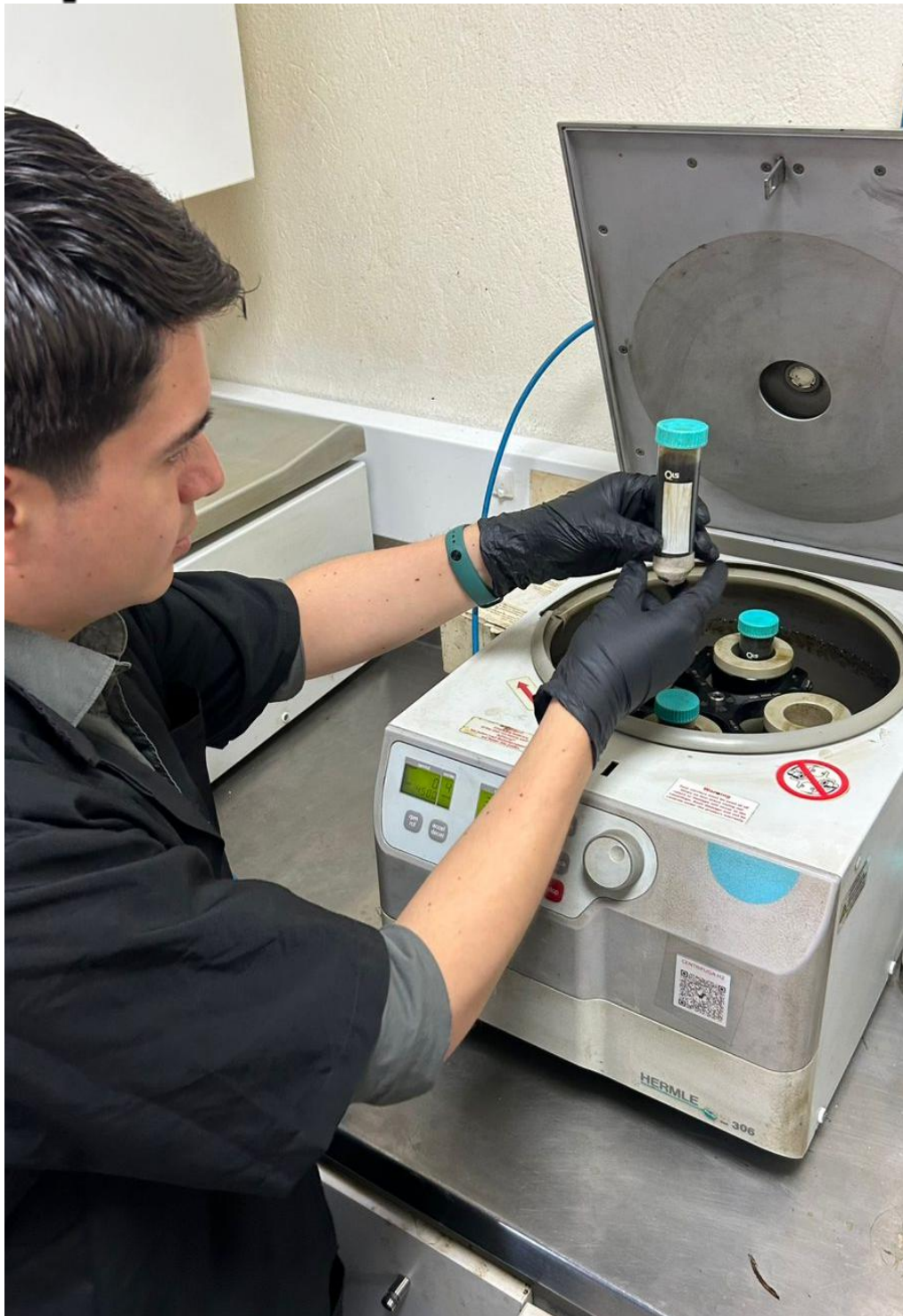
Figura 13. Separación de fase acuosa y oleosa para los ensayos de tensión interfacial.
