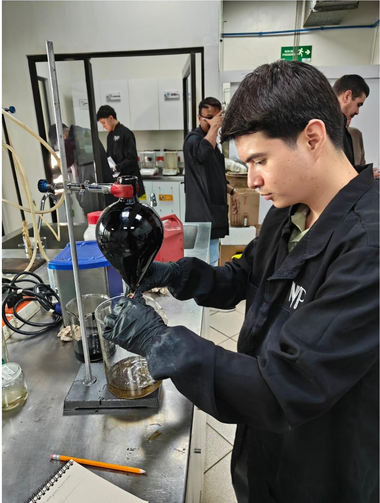
Figura 2. Remoción de exceso de agua en el crudo por decantación.
