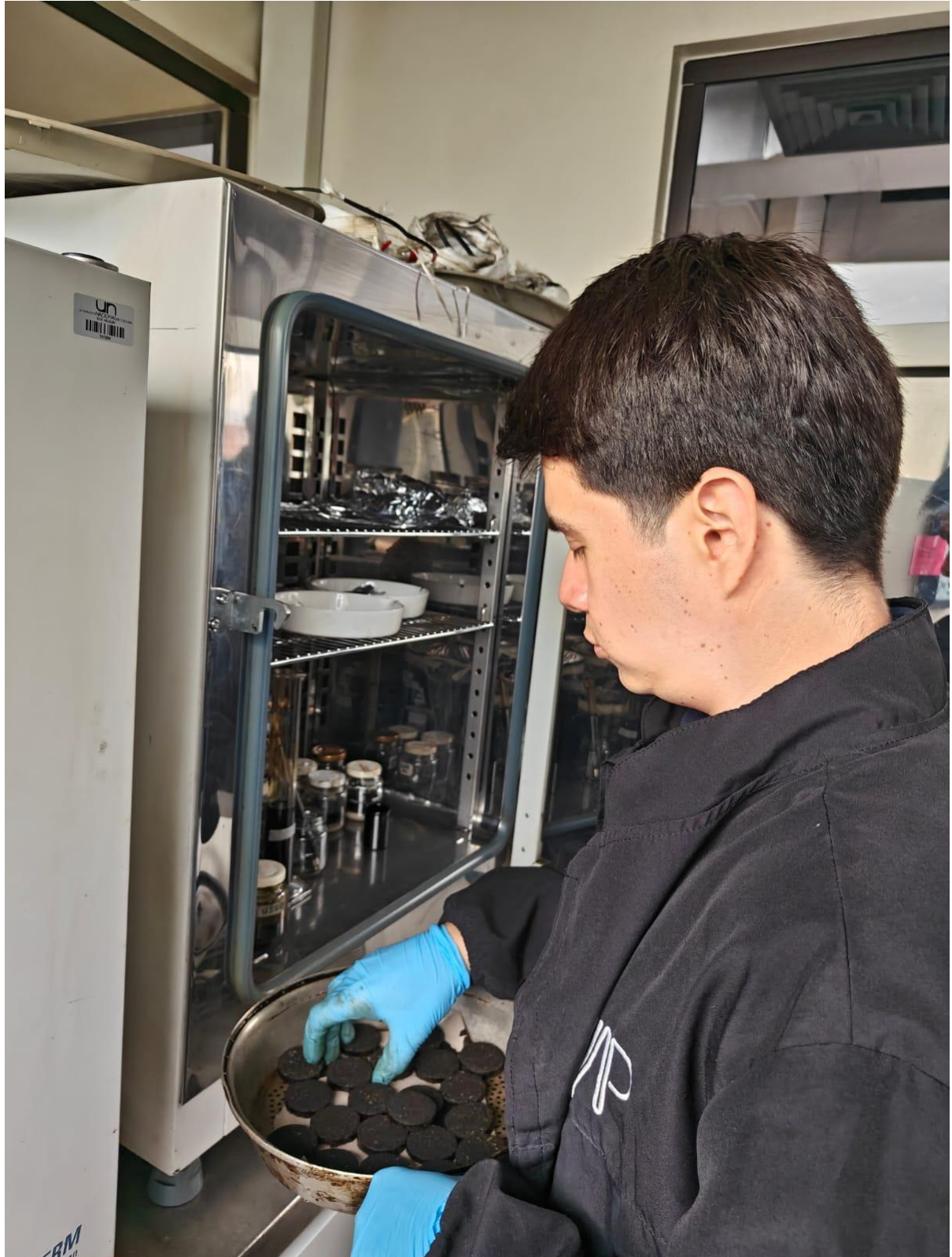
Figura 10. Envejecimiento/añejamiento de núcleos con crudo.
