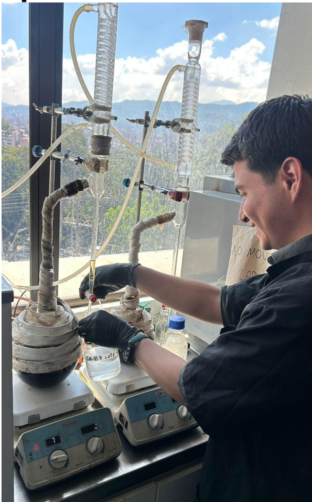
Figura 4. Remoción de exceso de agua y conservación de compuestos aromáticos por procesos térmicos.
