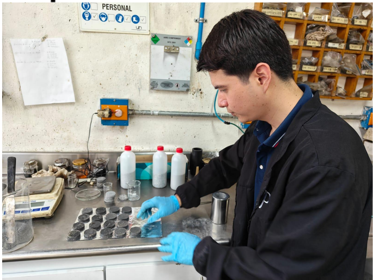
Figura 9. Núcleos producidos por el proceso de prensado.
