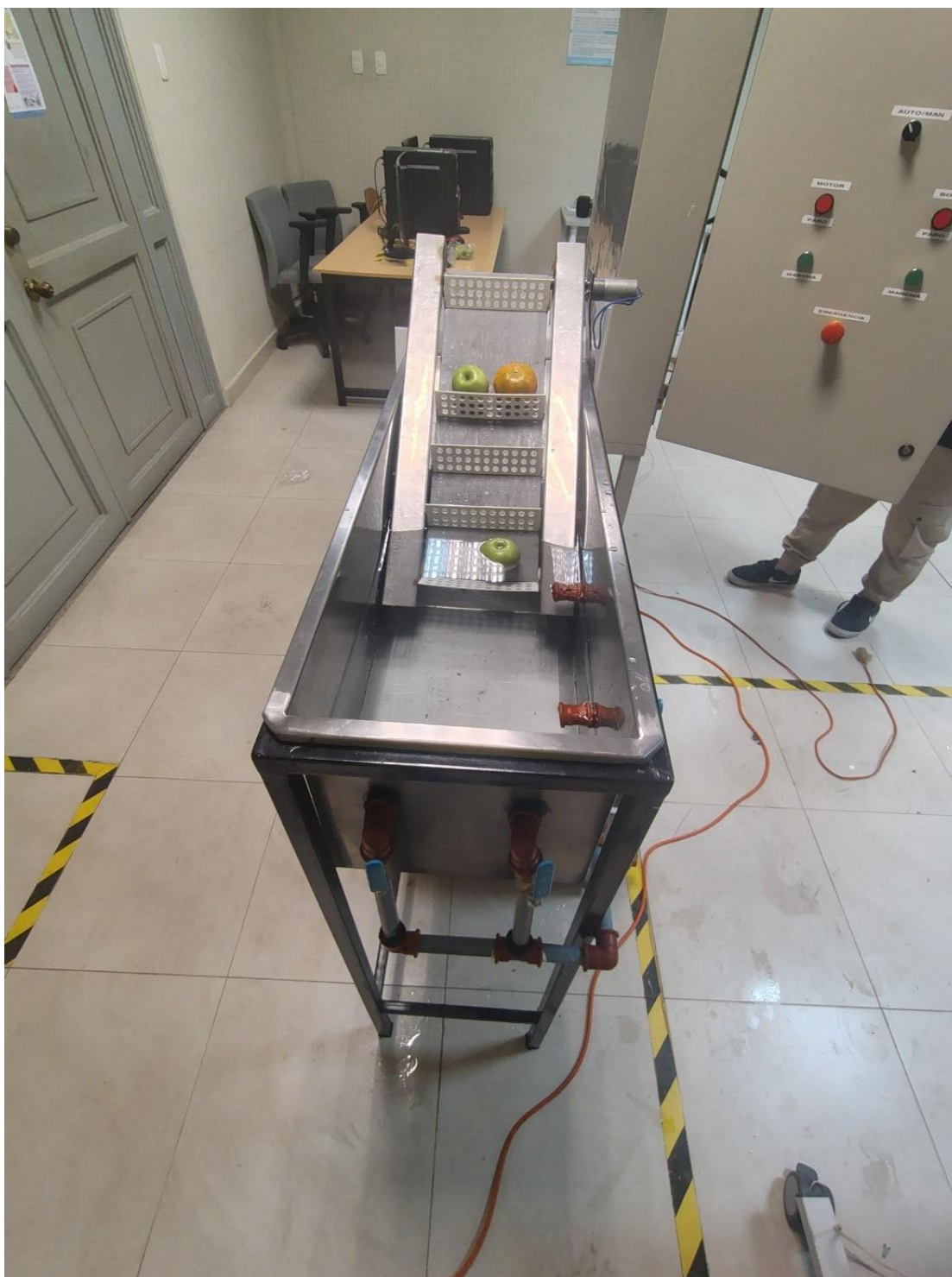
Tina de lavado implementada con la banda y aspas subiendo las frutas
