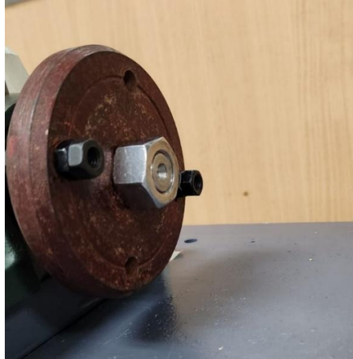
Figura 2.14 Masa añadida para el desbalanceo por par
