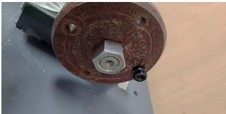
Figura 2.13 Masa añadida para el desbalanceo estático
