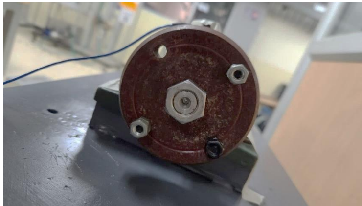
Figura 2.15 Masa añadida para el desbalanceo angular
