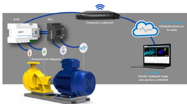
Figura 1.1 Ejemplo de sistema de monitoreo continuo con sensores conectados a PLC (AMAQ, 2022)
