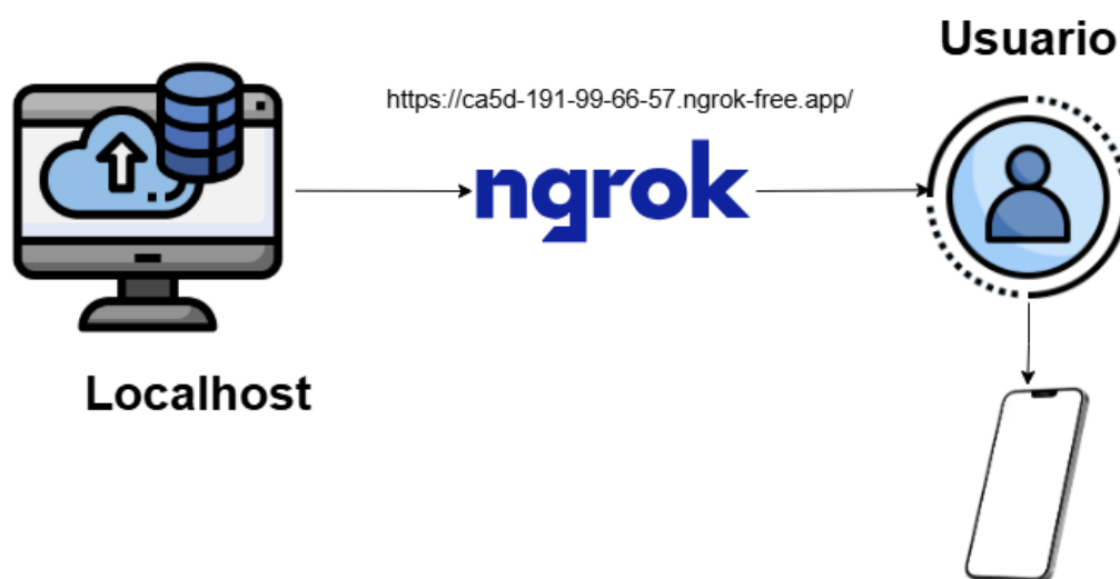
Figura 2.5 Acceso remoto al sistema mediante Ngrok
