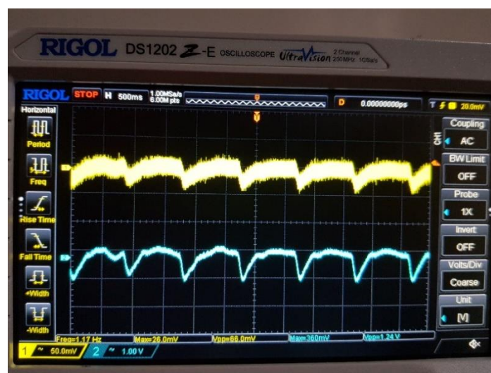
Figura 3. 26 Señal del fotodiodo amarillo y señal filtrada y amplificada azul
