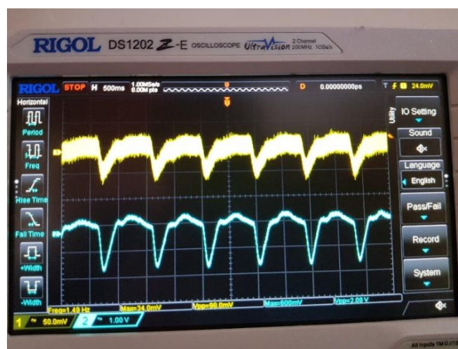
Figura 3. 23 Señal del fotodiodo amarillo y señal filtrada y amplificada azul
