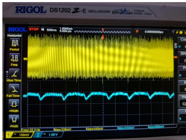
Figura 3. 24 Señal del fotodiodo amarillo y señal filtrada y amplificada azul
