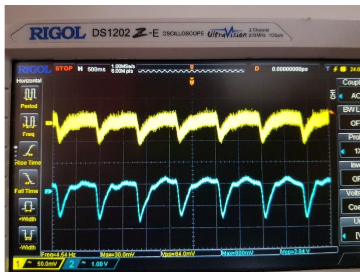
Figura 3. 22 Señal del fotodiodo amarillo y señal filtrada y amplificada azul
