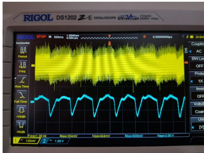
Figura 3. 21 Señal del fotodiodo amarillo y señal filtrada y amplificada azul
