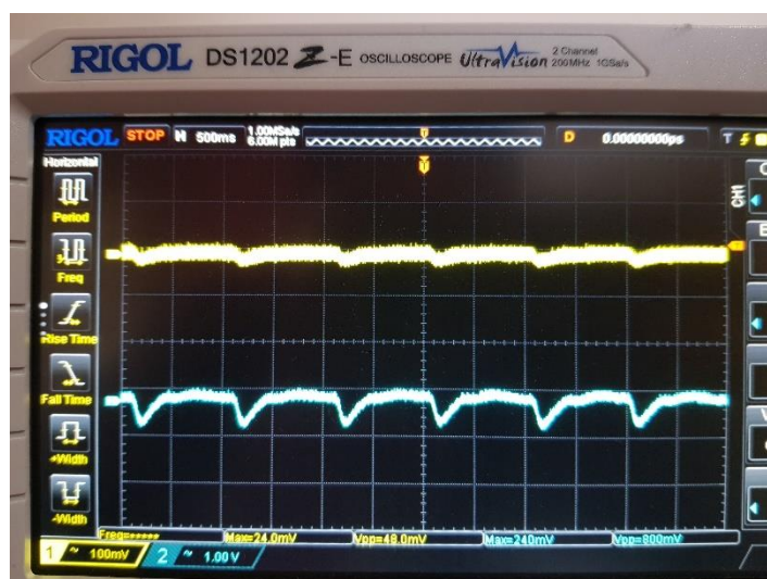
Figura 3. 25 Señal del fotodiodo amarillo y señal filtrada y amplificada azul
