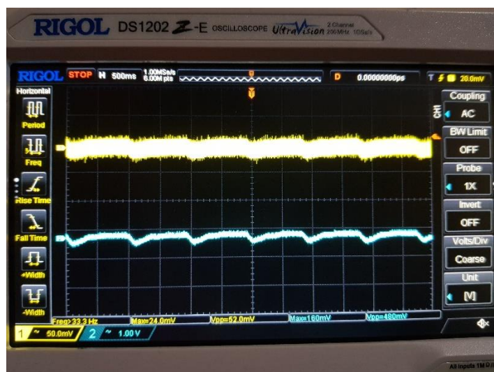
Figura 3. 28 Señal del fotodiodo amarillo y señal filtrada y amplificada azul
