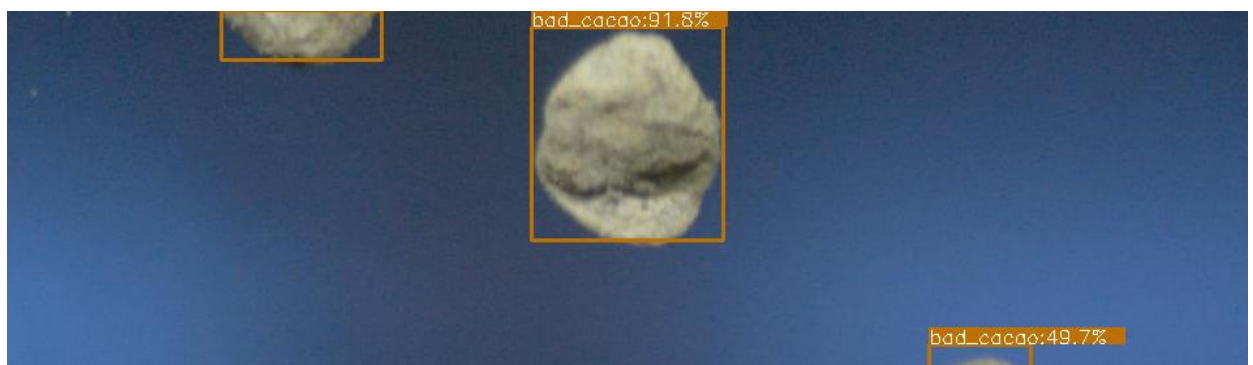
Figura 37 Resultado de inferencia YOLO-NAS: granos de cacao clasificados como defectuosos.
