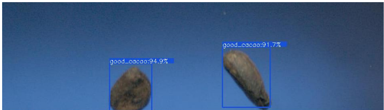
Figura 36 Resultado de inferencia YOLO-NAS: granos de cacao clasificados como buenos.
