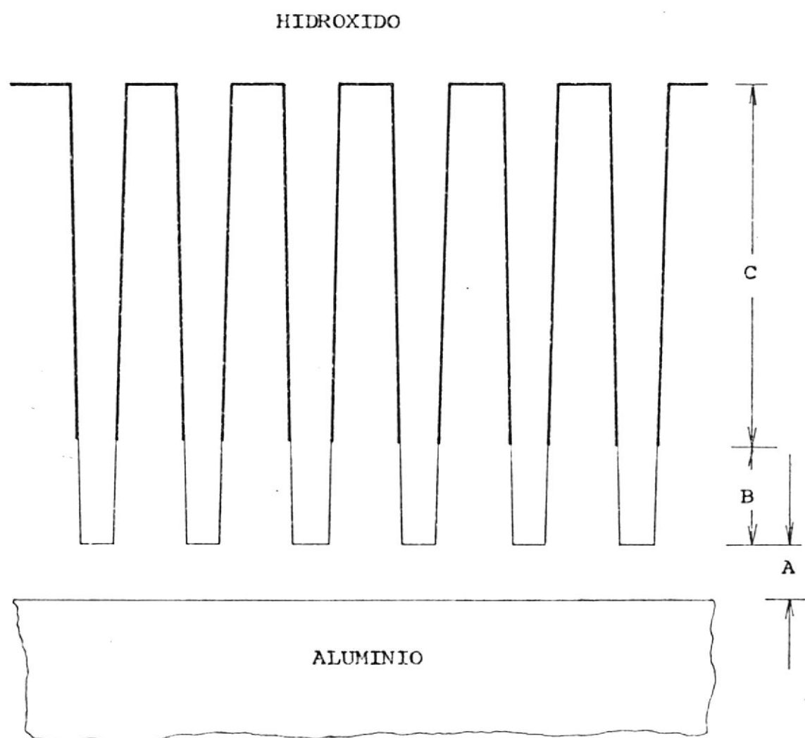
Fig. No. 3 DIAGRAMA QUE MUESTRA LA FORMACION DE UNA PELICULA ANODICA DE OXIDO.
