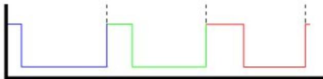
Figura 2.10 PWM para recorrer todo el rango de operación del servo
