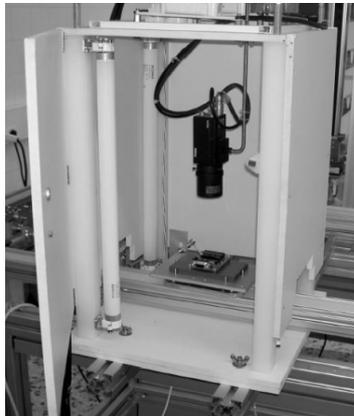
Figura 1.3 Se verifican las pistas de placas PCB
