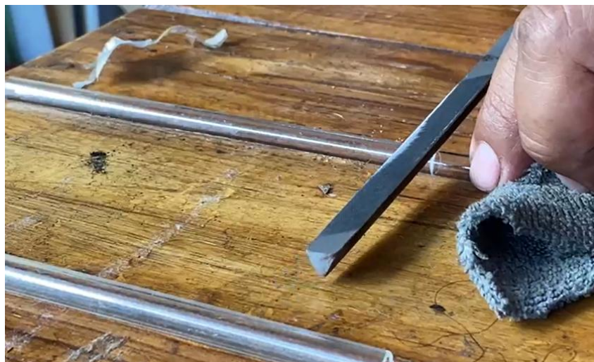
Elaboración de tubos de vidrio para medidor de calidad de vapor
