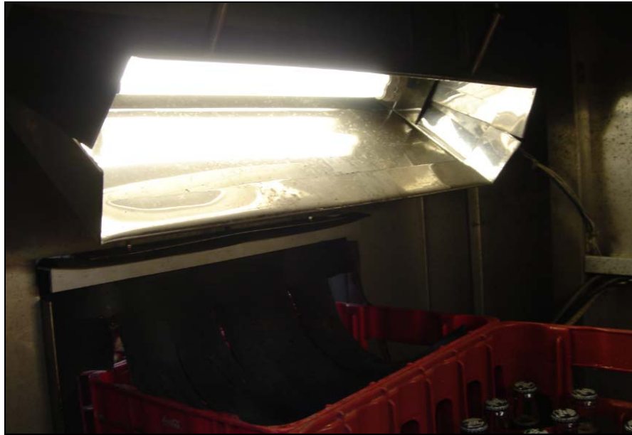
Figura 1.1.2 Iluminación del inspector de cajas
