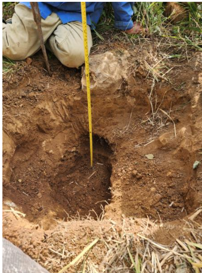
Figura 5 Muestra de la calicata 1 medida a 1 metro de profundidad
