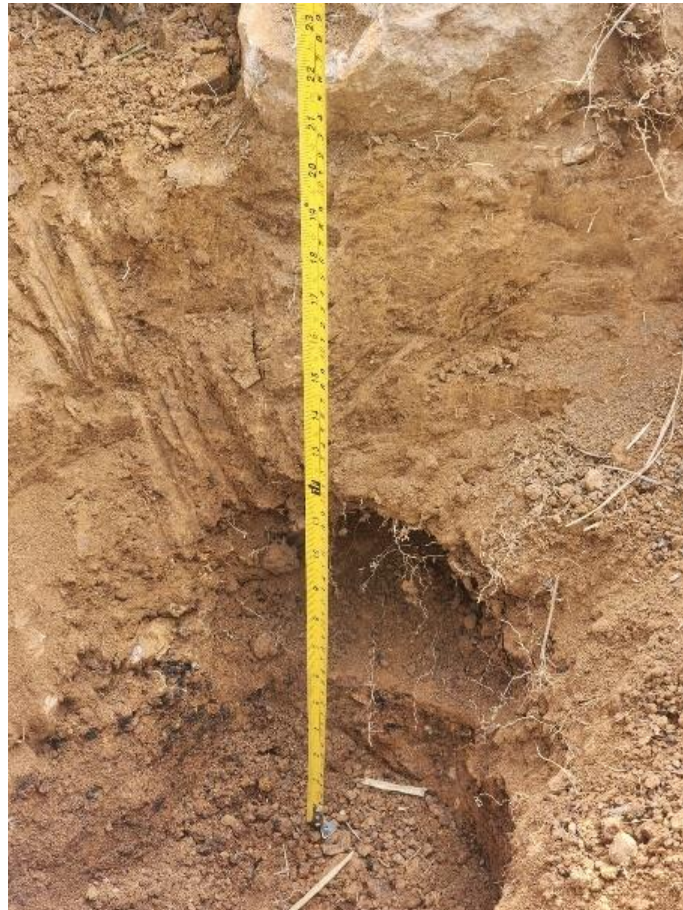
Figura 8 Profundidad de excavación de la calicata 3.
