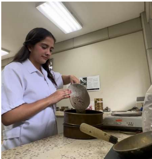
Figura 25. Tamizado de la muestra seca
