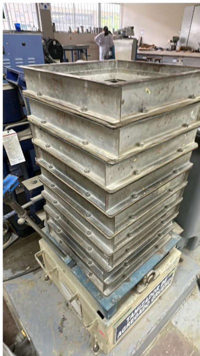
Figura 23. Muestra colocada en la tamizadora de material grueso
