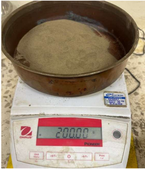
Figura 26. Material pasante por el tamiz No. 40 (200g)
