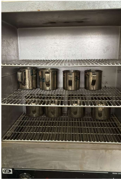
Figura 34. Muestras de cada mezcla húmeda para secar en el horno.
