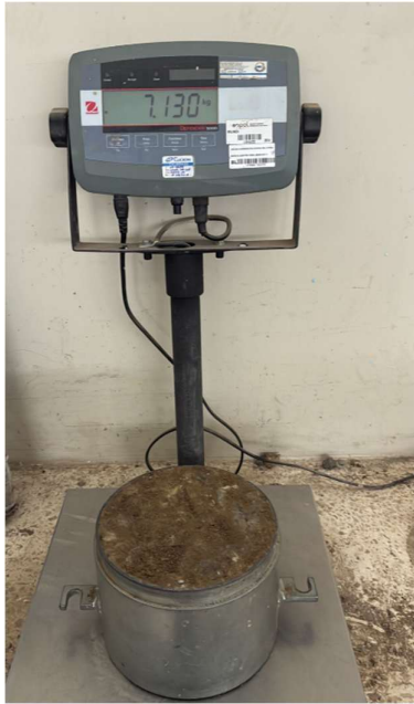
Figura 35. Molde compactado con 5 capas.
