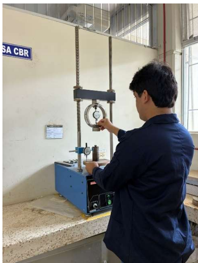
Figura 36. Ensayo CBR en laboratorio
