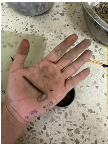
Figura 31. Hilos de 3.2 mm de diámetro de la muestra de suelo
