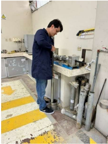
Figura 32. Ensayo Proctor realizado en laboratorio
