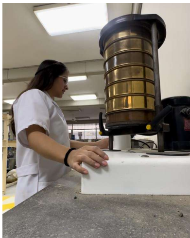
Figura 24. Muestra colocada en la tamizadora eléctrica de material fino
