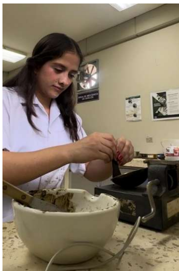
Figura 29. Trazado de canal con el ranurador
