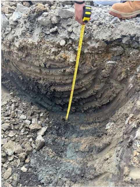
Figura 13. Estratigrafía de la primera calicata
