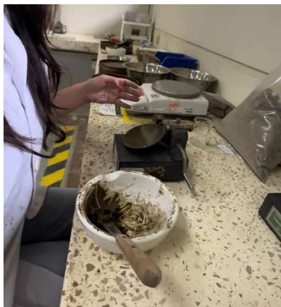
Figura 28. Colocar la muestra en la Copa de Casagrande.
