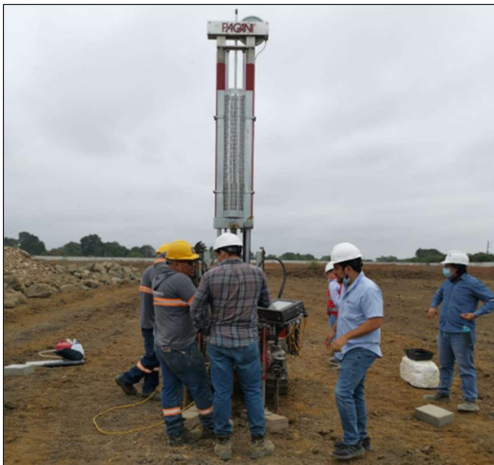
Gráfico 17 Ejecución de ensayo CPTu por parte de Geocimientos S.A.
