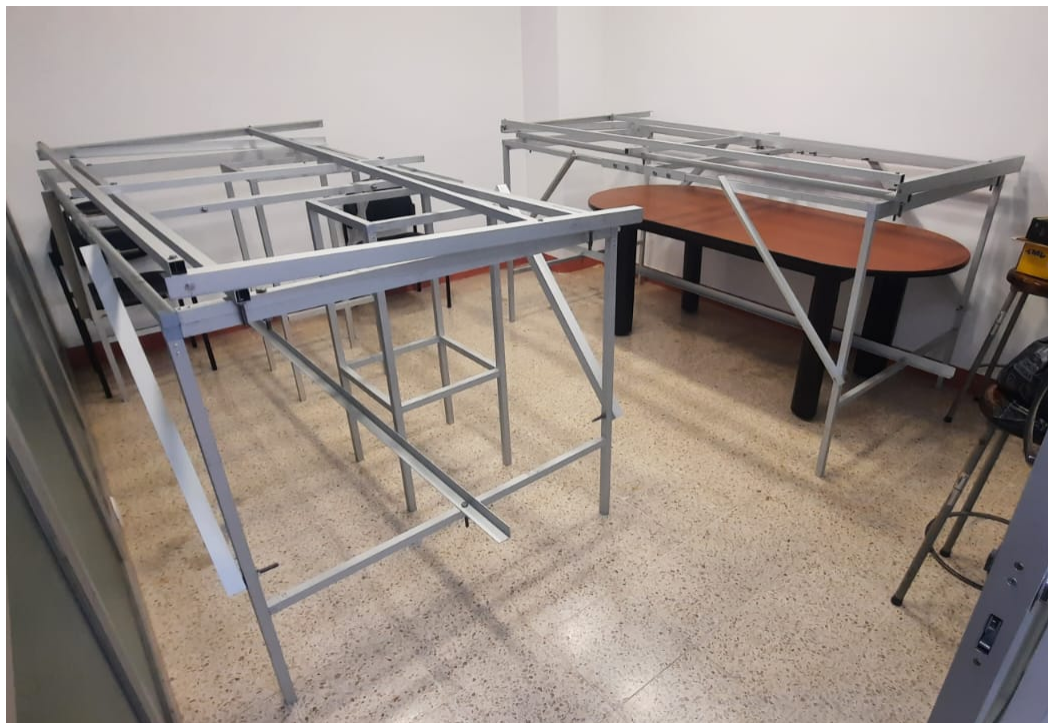
Figura 2.7. Estructura modular ensamblada con perfilera de tubo cuadrado de 1"
