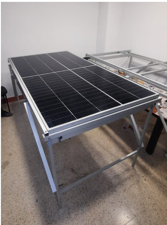
Figura 2.8. Panel Solar montado sobre la estructura armada
