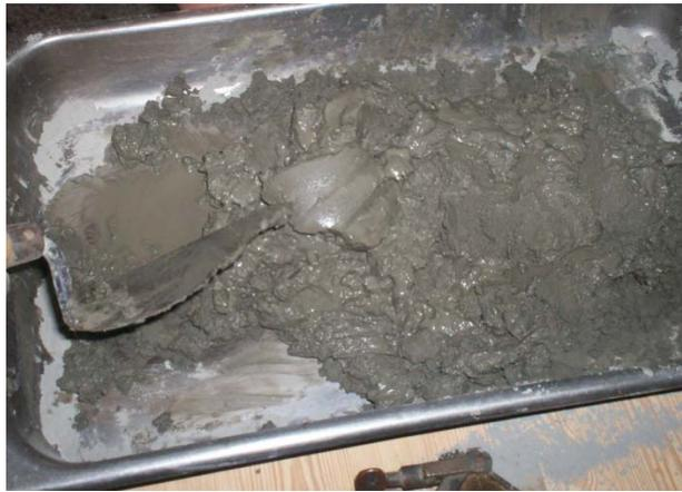
**FIGURA 3.19. OBTENCIÓN DE LA PASTA DE CEMENTO
