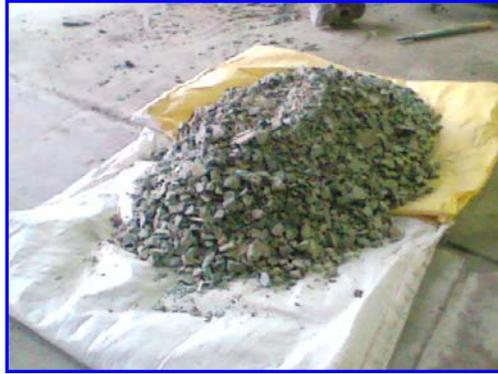
**FIGURA 3.8. ZEOLITA AL SALIR DE MOLINO DE MANDÍBULAS.**
