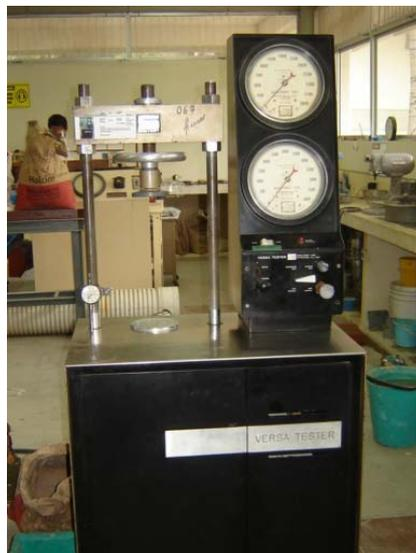
**FIGURA 3.6. MÁQUINA DE ENSAYOS UNIVERSAL**
