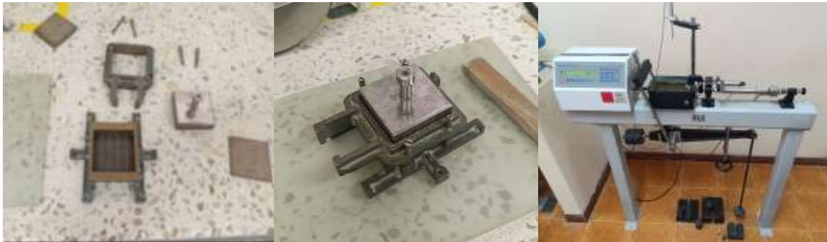
Figura 11 Ensayo de corte directo y la caja triaxial para la muestra
