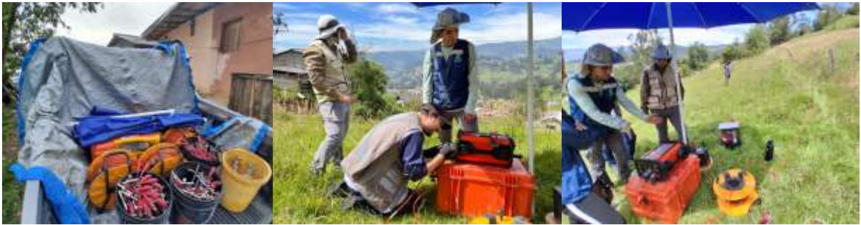
Figura 12 Ensayo de TRE gradiente en Zhindilig
