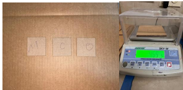
Figura A. 4 Preparación y ensayo de peso básico
