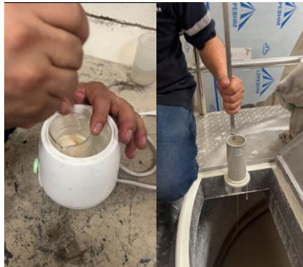
Figura A. 2 Medición de Viscosidad y Punto Gel en Cocina de Almidón
