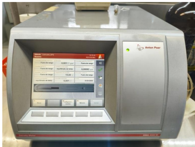
Figura 2.1 Densímetro digital Anton Paar DMA 4500 M empleado para la determinación de densidad de lubricantes conforme a ASTM D4052-22.
