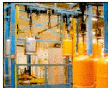
Paseo automático de botellas del transportador a sistema al sistema transportador aéreo
