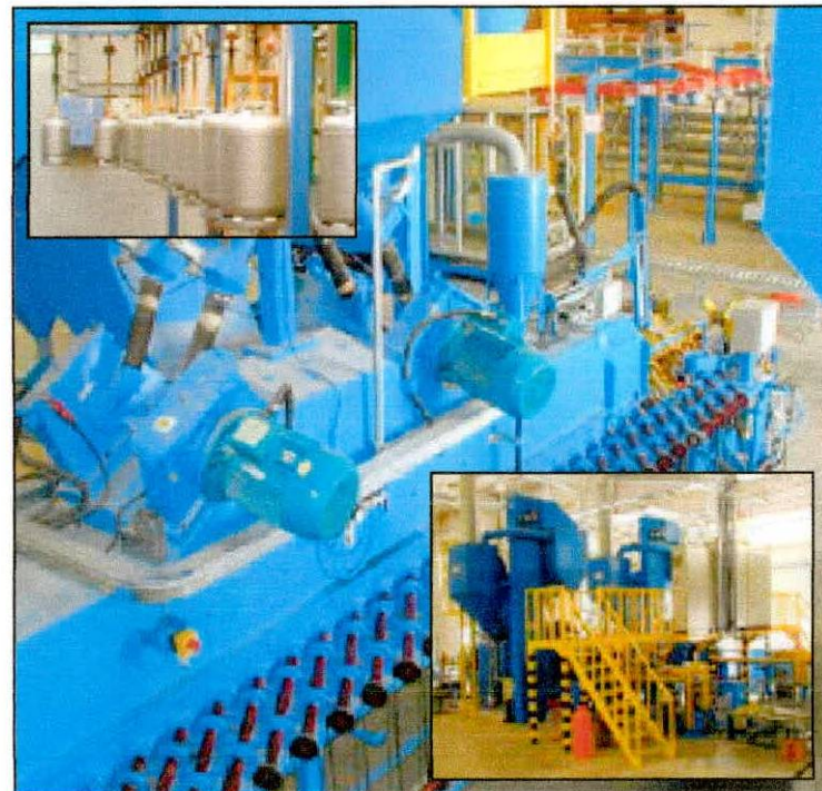
Equipos de granallado con carga y descarga automática de botellas
