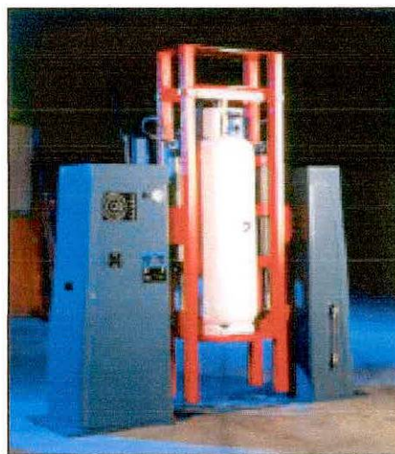
Unidad PTV de prueba de presión para botellas industriales
