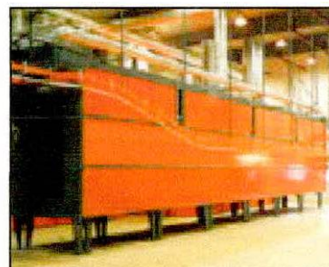
Horno de línea de secado después de tratamiento inicial, en el momento de secado de pintura fresca o endurecimiento de pintura en polvo
