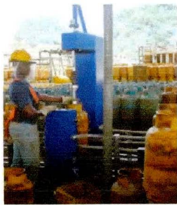
FOTO 5: EQUIPO QUE SACA LA VÁLVULA DEL CILINDRO
