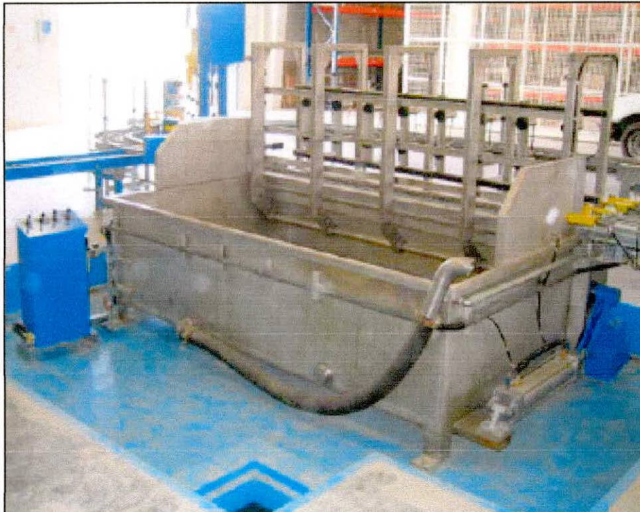
Dispositivo semi-automático E23-8 para prueba de hermeticidad integrado en transportador o cadena con rechazo de botellas con fugas
