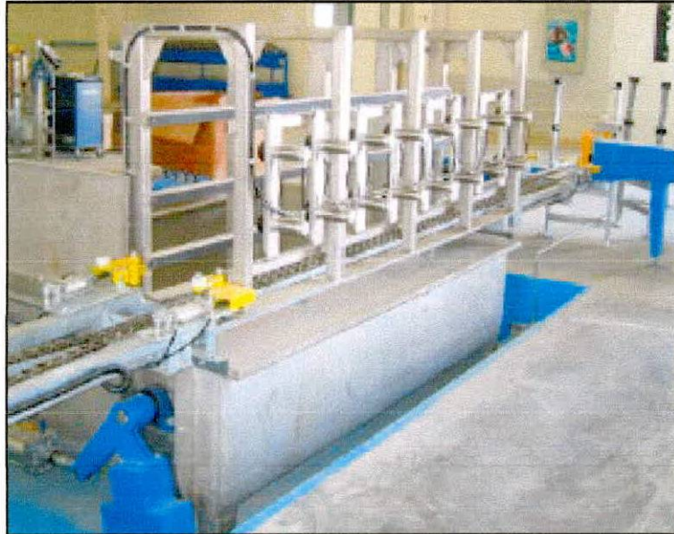
Dispositivo semi-automático E23-8 para prueba de hermeticidad integrado en transportador o cadena con rechazo de botellas con fugas
