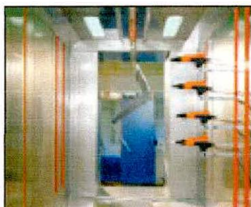
Cabina de pintura para aplicación automática y reposición de pintura en polvo
