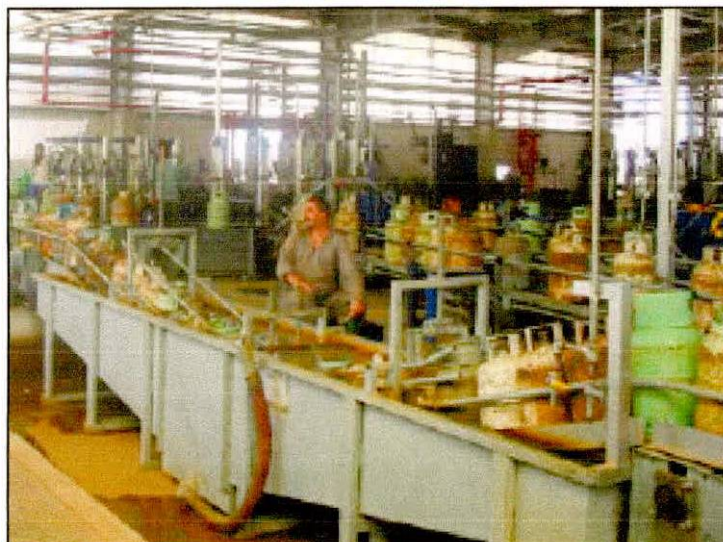
Dispositivo PCD para prueba de hermeticidad integrado en transportador a cadena
