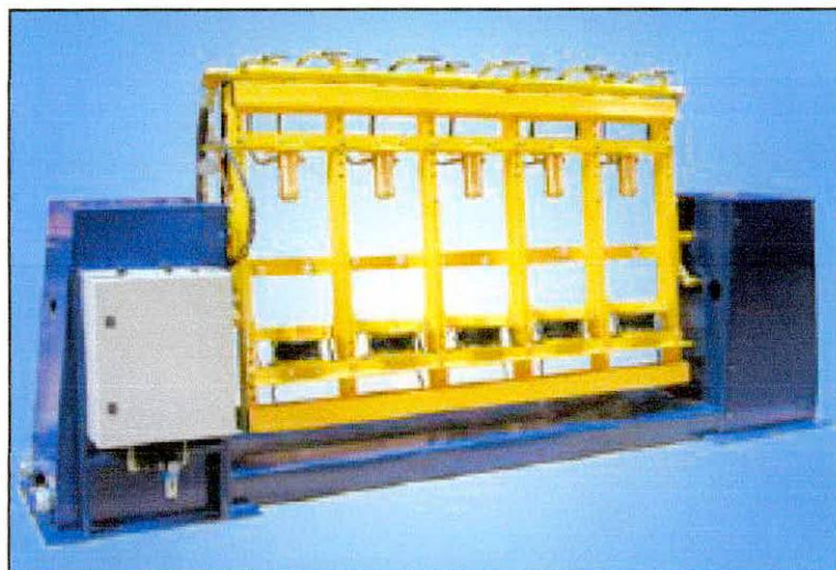
Soporte fijo PTL-5 de prueba de presión para botellas domésticas
