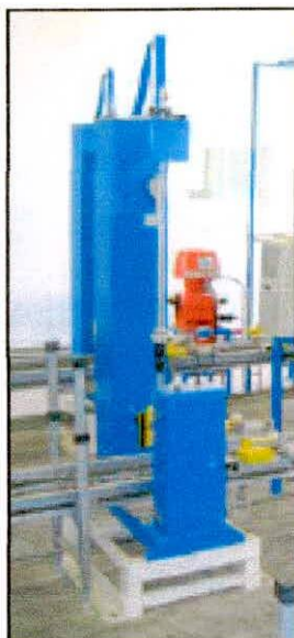
Máquina pone y saca válvulas PVS para instalación en transportador a cadena
