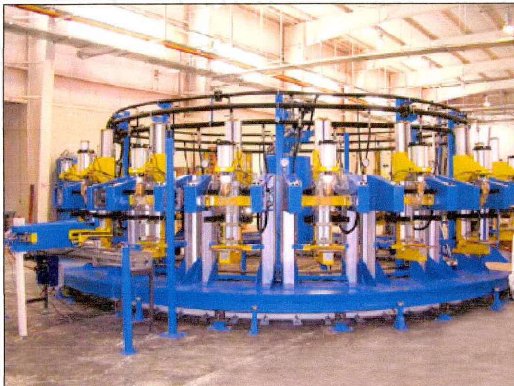
Camión PTC de prueba de presión para botellas domésticas
