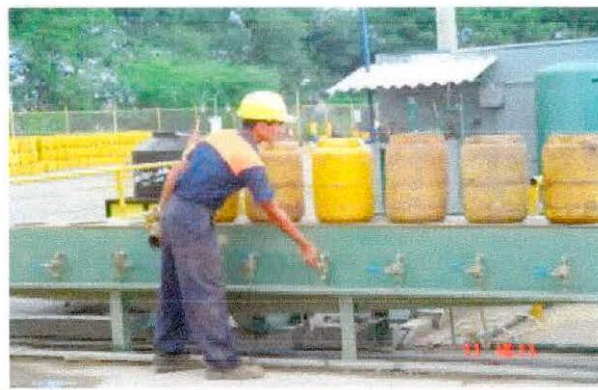
FOTO 2: SISTEMA DE PULVERIZADO INTERNO DEL CILINDRO
