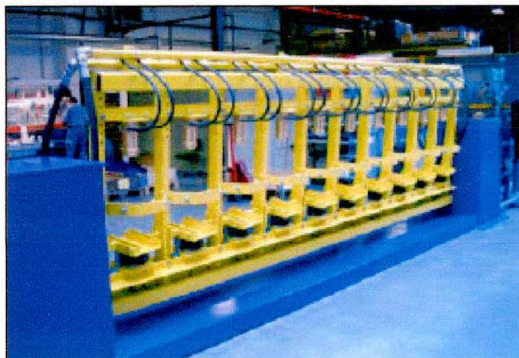
Soporte fijo PTL-10 de prueba de presión para botellas domésticas
