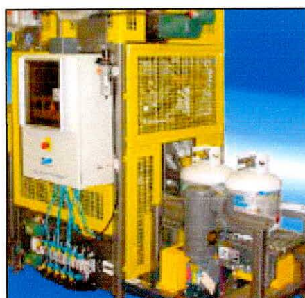
Aplicador de tinta para todo el cuerpo de la botella
