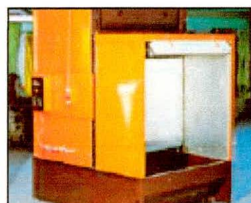
Cabina de pintura para aplicación manual de pintura fresca
