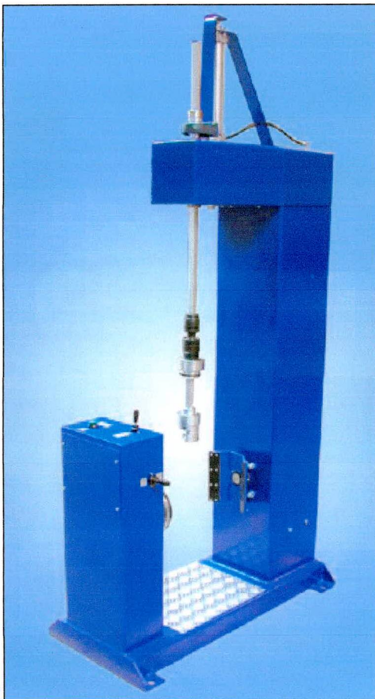
Máquina pone y saca válvulas PVS para instalación en el suelo
