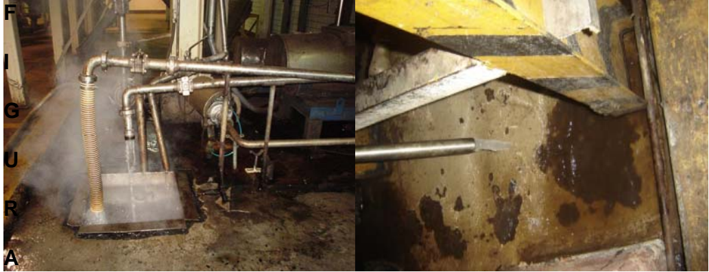
FIGURA 2.31 PÉRDIDAS DE CONDENSADO ORGÁNICO
