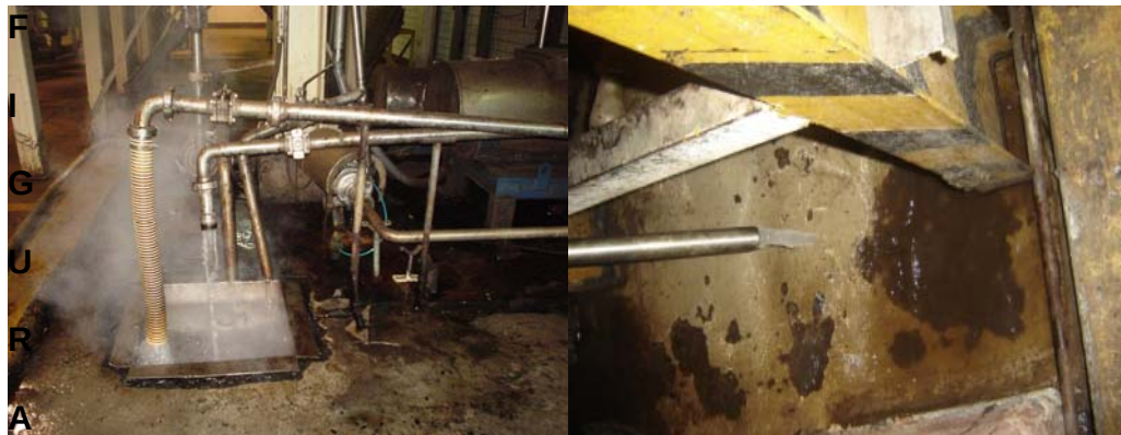
FIGURA 2.31 PÉRDIDAS DE CONDENSADO ORGÁNICO
