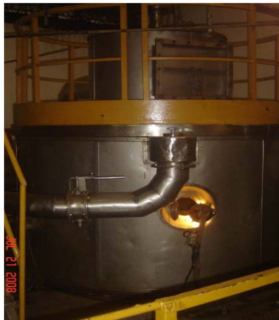
FIGURA 2.11 CÁMARA DE AGLOMERADO
