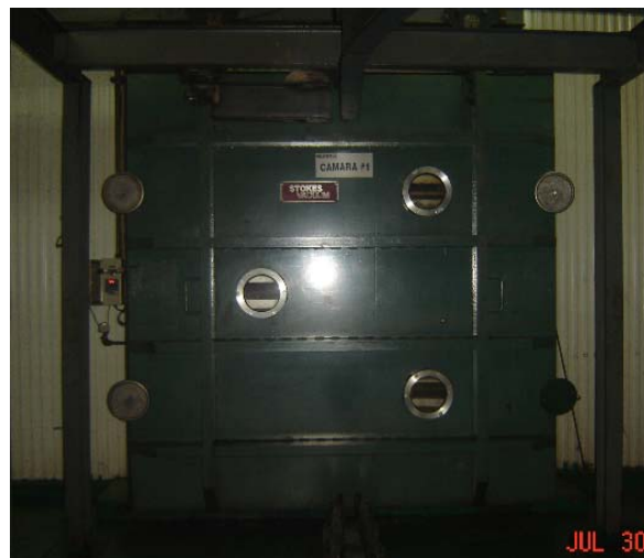
FIGURA 2.23 CÁMARA DE SECADO
