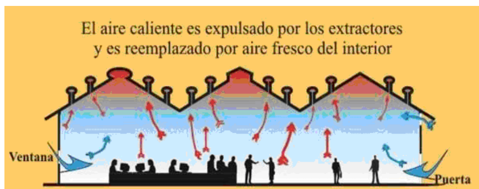
FIGURA 2.11 FUNCIÓN QUE REALIZA UN EXTRACTOR EÓLICO
