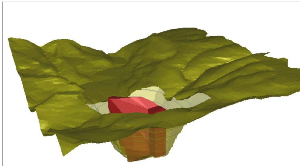
Figura 8.3. Posible tajo abierto del sector mineralizado Suroeste a partir de reservas inferidas.
