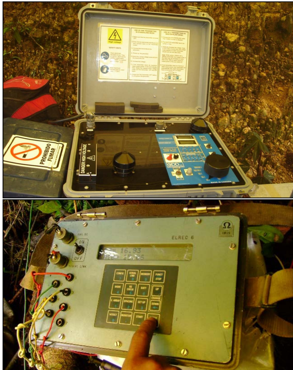
Fotografía 7.5. Instrumentos usados durante la última campaña de Polarización Inducida y Magnetometría.
