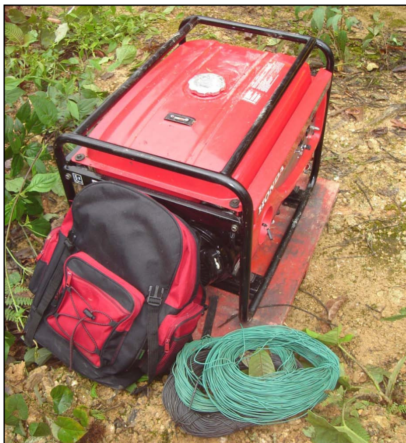
Fotografía 7.4. Generador de electricidad usado durante el trabajo de polarización inducida.
