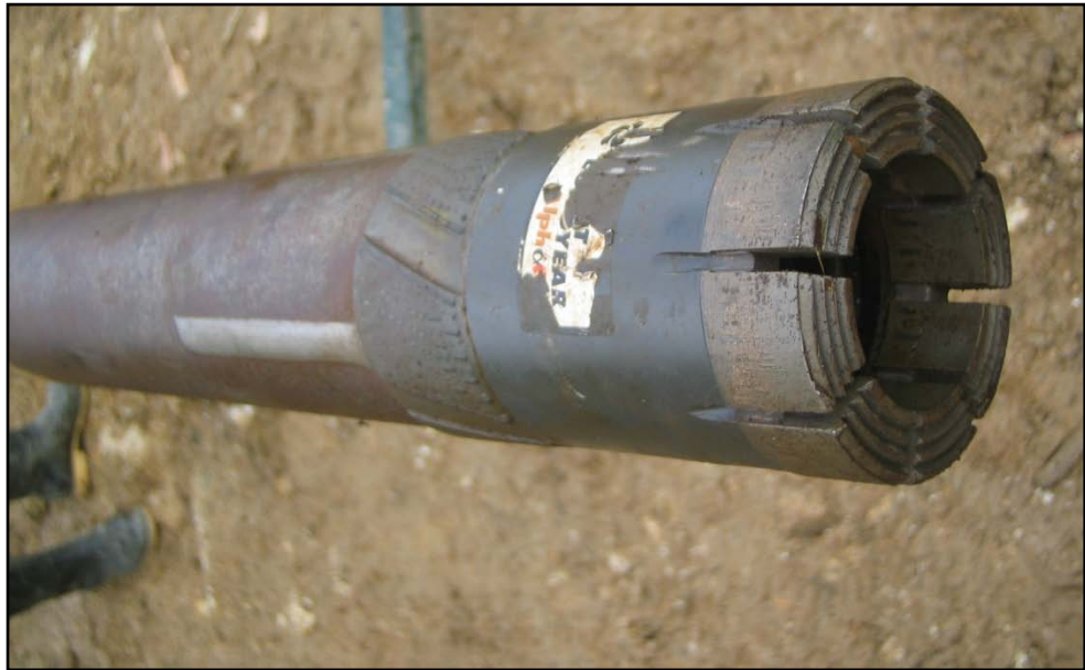
Fotografía 7.9. Broca usada para la perforación diamantina.
