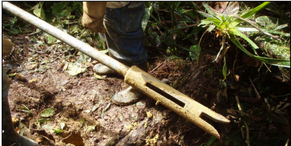
Fotografía 7.2. Preparación del Auger.
