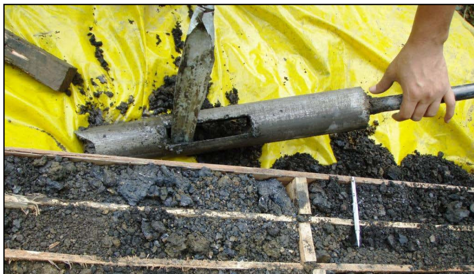
Fotografía 7.1. Cilindro helicoidal en el extremo del Auger, descargando la muestra tomada.
