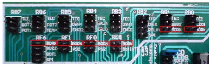
Figura 04.40. Habilitadores de salida por bornera
