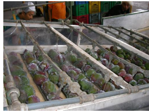
Figura 6 Sistema de limpieza
