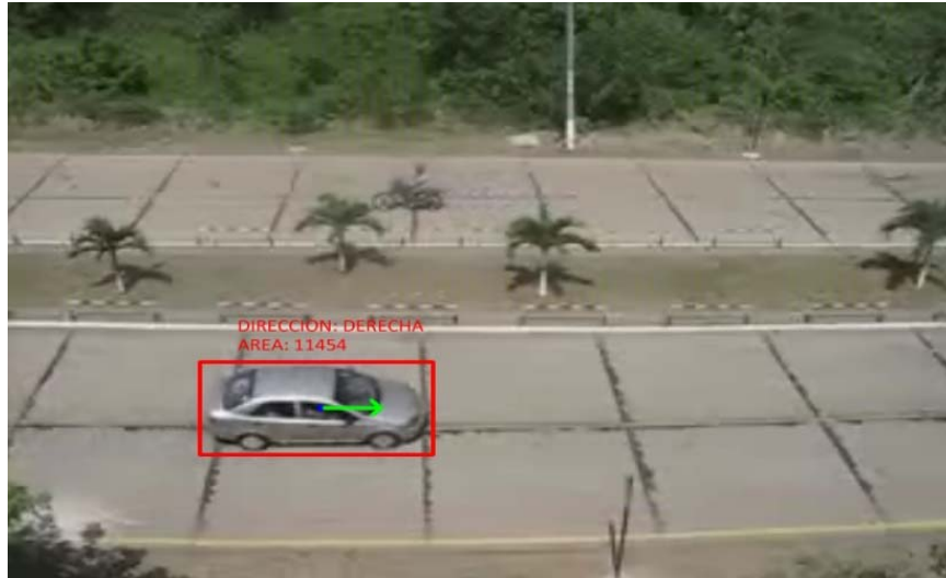
Figura 28 Una moto cruzando y auto, siendo solo el automotor detectado
