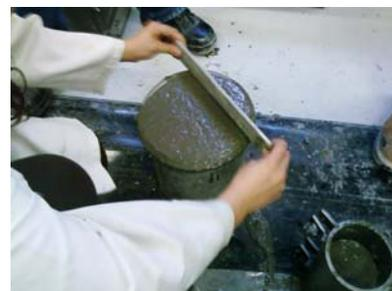
*Figura # 3.1 Ensayo para determinar la Densidad*
