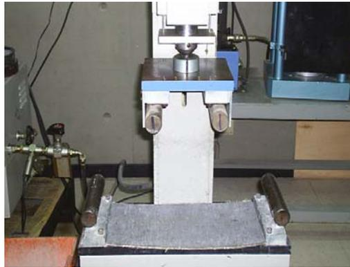
*Figura # 4.3 Equipo utilizado prensa "ELE" 3000 kN.*
