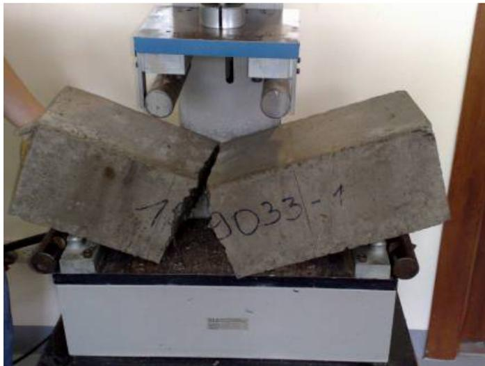
*Figura # 4.5 Viga ensayada a flexión*
