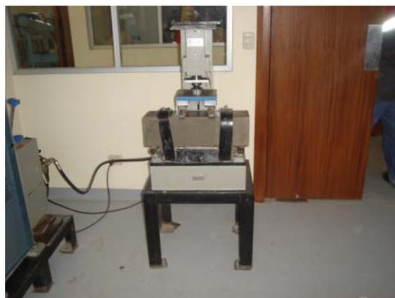
*Figura # 4.4 Ensayo Resistencia a la Flexión*
