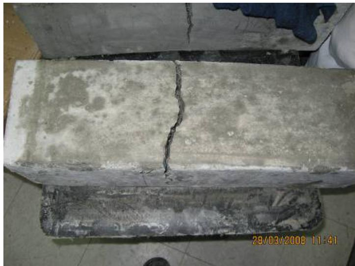
*Figura # 4.6 Aspecto de la viga de ensayada a flexión*
