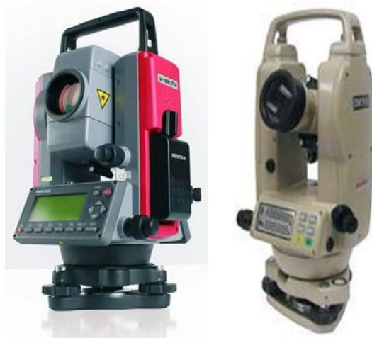
FIGURA 3.5 y 3.6: Estación Total y Teodolito
