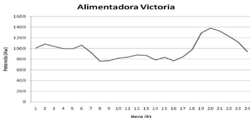
**Figura 30 Curva de carga de Alimentadora Victoria**
