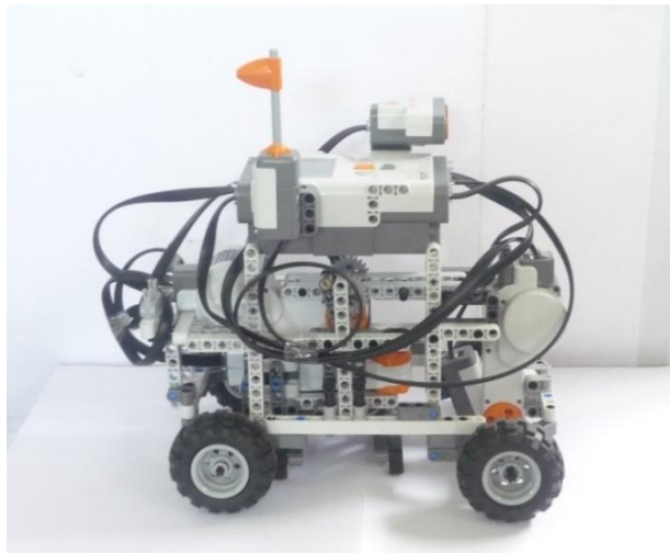
Fig. 3.1.2.3: Ubicación de los Sensores de Tacto y Ultrasonido
