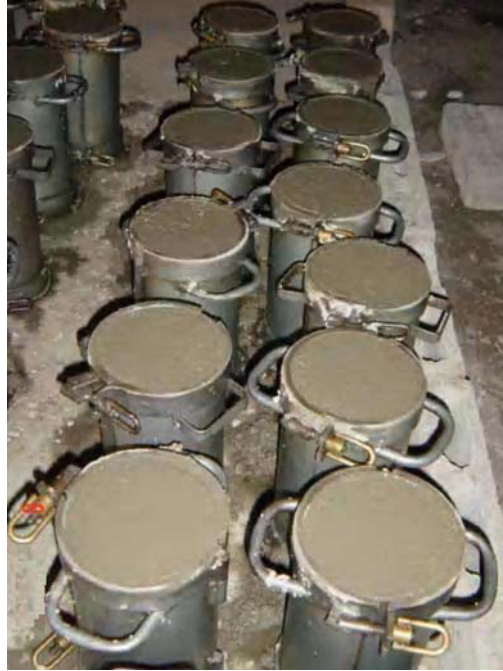
Fotografía 4.2.- Cilindros de hormigón para ensayo de compresión.
