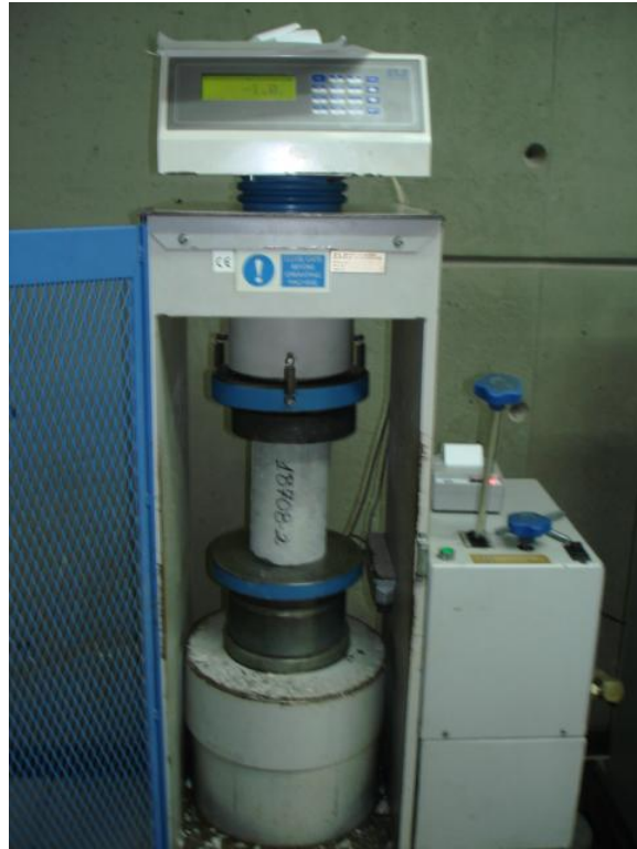
Figura № 1 Prensa para el ensayo de resistencia a la compresión de cilindros
