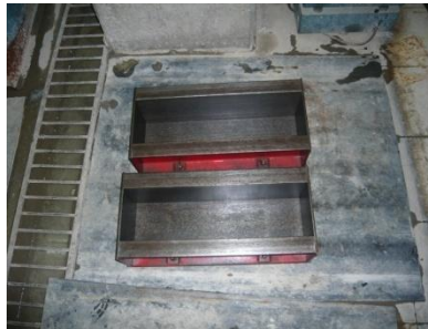
FIGURA 4.11 Moldes metálicos vigas de 150x150x500mm
