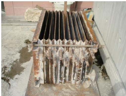
FIGURA 5.1 Molde para la elaboración de paneles
