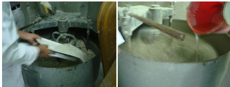
FIGURA 4.5 Colocación de los materiales y las 2/3 partes de Agua a la mezcla
