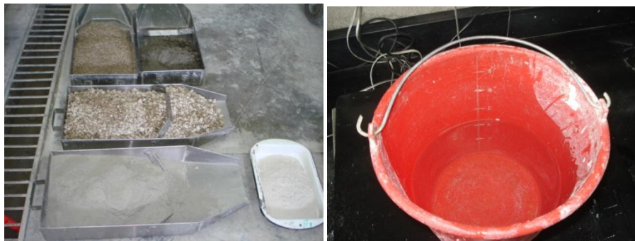
FIGURA 4.1 Cemento, Agregados, Filler y Agua para la mezcla
