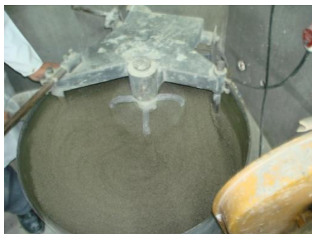
FIGURA 4.8 Mezcla de Hormigón Liviano con Agregado volcánico
