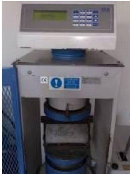
Figura № 2 Prensa para el ensayo de tracción por compresión de cilindros (Método Brasileño)
