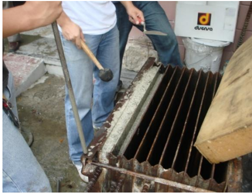
FIGURA 5.4 Golpe del molde con el martillo de goma
