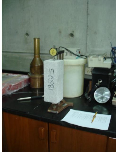
Figura № 3 Toma de lecturas de retracción en Deformímetro
