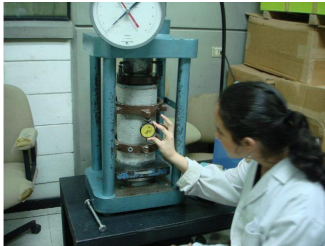
Figura № 4 Prensa para realizar el ensayo Modulo de Elasticidad de los cilindros
