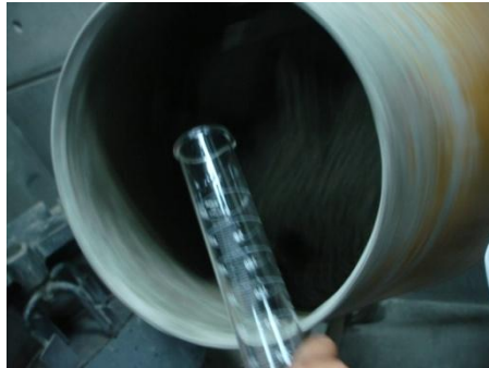
FIGURA 4.7 Colocación del Aditivo incorporador de aire en la mezcla
