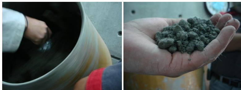
FIGURA 4.6 Colocación de la Fibra de Polipropileno en la mezcla
