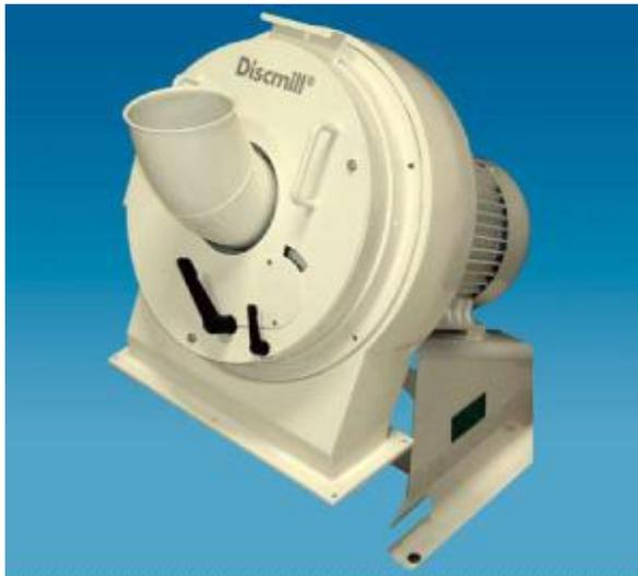
El molino está diseñado para hacer la molienda gruesa de los cereales y productos parecidos. Los discos tienen en su superficie un material fuerte corrugado y la distancia entre los discos se puede variar y en si se puede controlar el grado de molienda del material. El control de la distancia se puede
