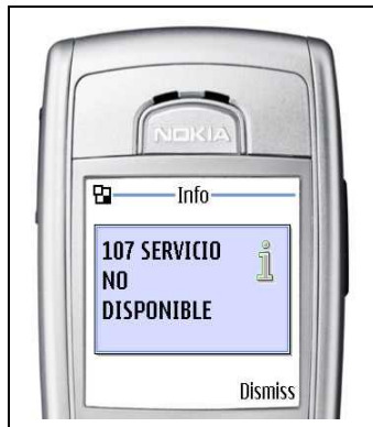
Figura 4.16 Mensaje mostrado al usuario en caso de que el número de tarjeta para el que se solicita autorización no corresponde al rango de bins del emisor.
