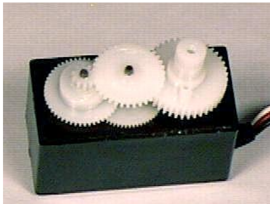
Figura 2.10: Detalle del tren de engranajes Del servo
