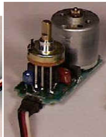
Figura 2.11: Detalle del circuito de realimentación del servo
