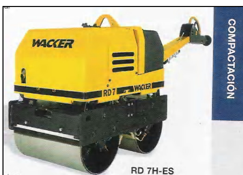
Figura 3.16 Equipo liviano de compactación: Rodillo Vibratorio Doble
