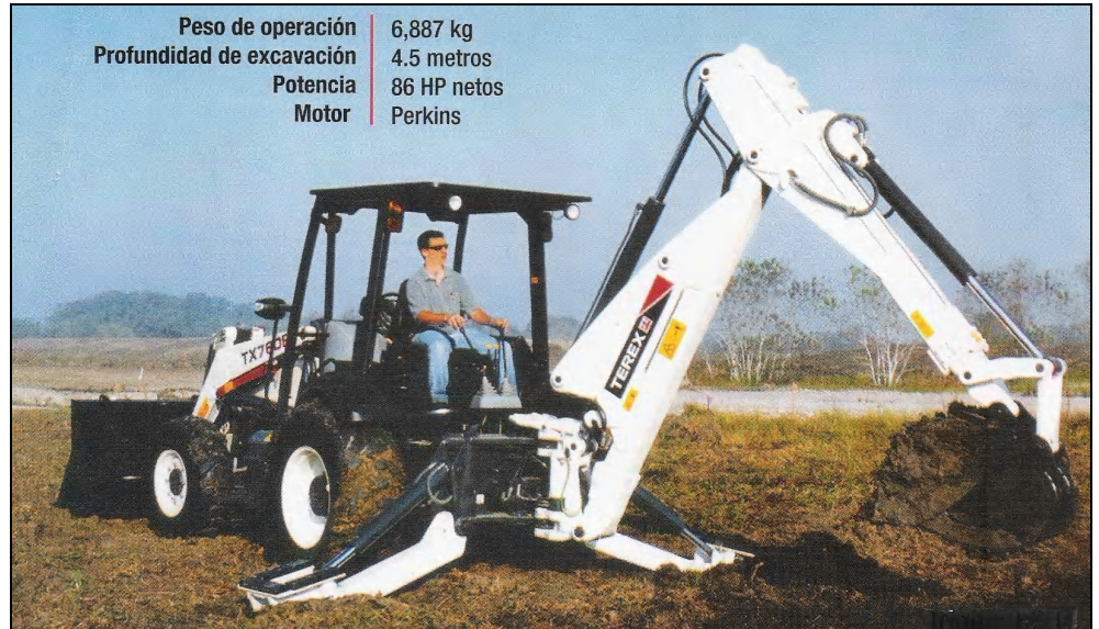
Figura 3.1 Retroexcavadora y sus especificaciones
