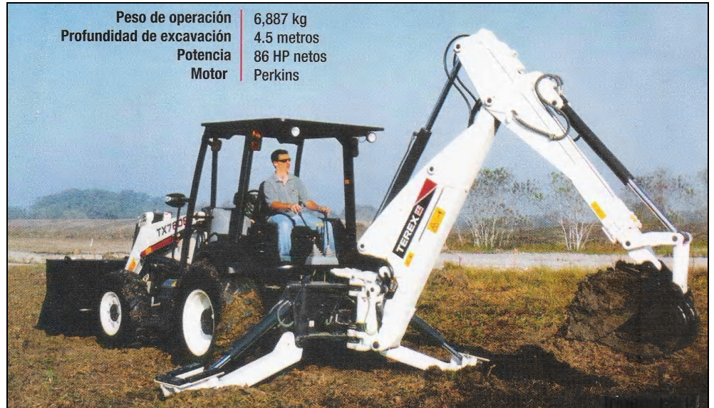
Figura 3.1 Retroexcavadora y sus especificaciones
