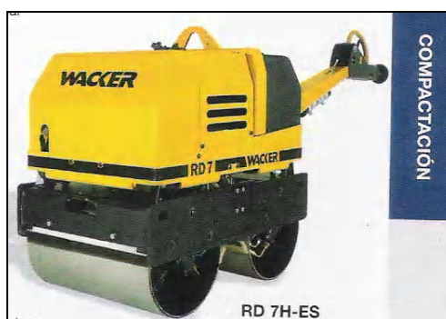
Figura 3.16 Equipo liviano de compactación: Rodillo Vibratorio Doble
