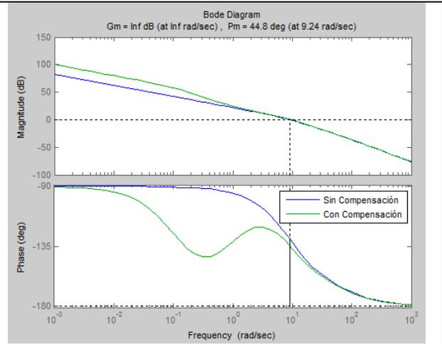
Se observa que se necesita sobrecompensar con 5° debido a la gran pendiente del ángulo en la zona a compensar.
