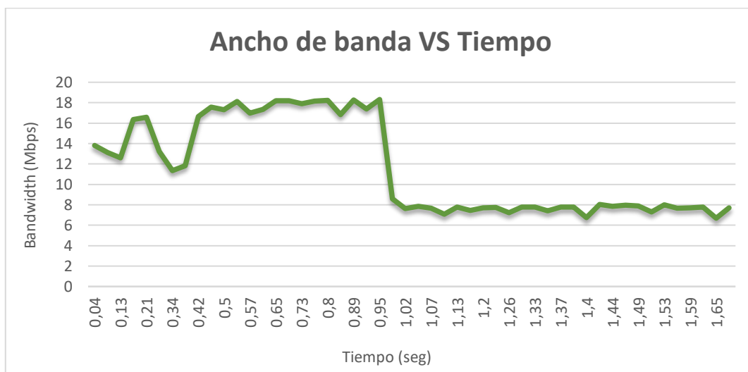
Figura 3.11: Gráfico de los datos de la prueba Hiperf en la máquina virtual del cliente.
