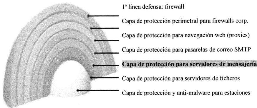
Diagrama 4: Ubicación por capas de los niveles de protección en la red
