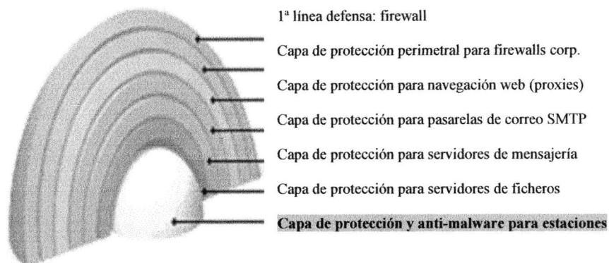
Diagrama 2: Ubicación por capas de los niveles de protección en una red.
